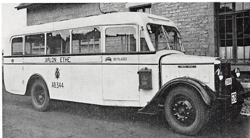
Un autobus vicinal de marque Brossel, avec carrosserie « Parisienne », mis en service dans le Luxembourg le 22 mars 1934. Remarquez la boîte postale à l'avant.
